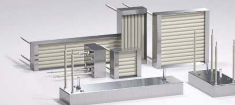
Излучатели серии ИКН-400 благодаря малой инерционности при разогреве и охлаждении рекомендуется применять в часто прерываемых за счет включения-выключения скоростных процессах инфракрасного нагрева (термоформование, термоусадка, локальный разогрев в режиме «термошока», сушка в камерах периодического действия, мобильные сушилки и т.п.), а также в циклических процессах разогрева с изменяемой по программе удельной мощностью излучения (инфракрасные паяльные станции).
