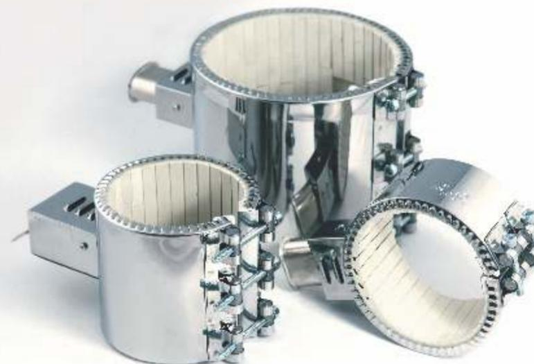
**Основной особенностью керамических нагревателей является резистивная проволока размещенная внутри керамических наборных изоляторов. Благодаря этому максимальная температура нагревателя может достигать 600°C.**
