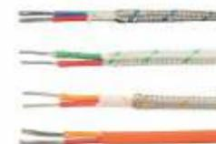
ПТН - провод с токопроводящими жилами из различных сплавов (хромель, алюмель, копель и т.д) с изоляцией из кремнеземной нити и экраном из жаростойкой проволоки. Провод предназначен для использования в качестве термоэлектродов/удлинительных проводов для преобразователей термоэлектрических. Термостойкий. Гигроскопичный.
